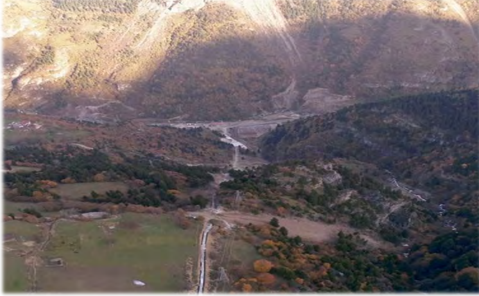
Fotoğraf 17 : Cebri boru hattı-Nebati toprak da kullanılarak kanal kapatılmış ve doğal yapıya uygun hale getirilmiştir.
